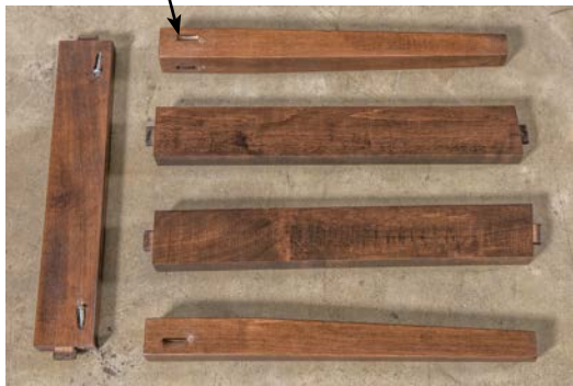
mortis & tenon construction
